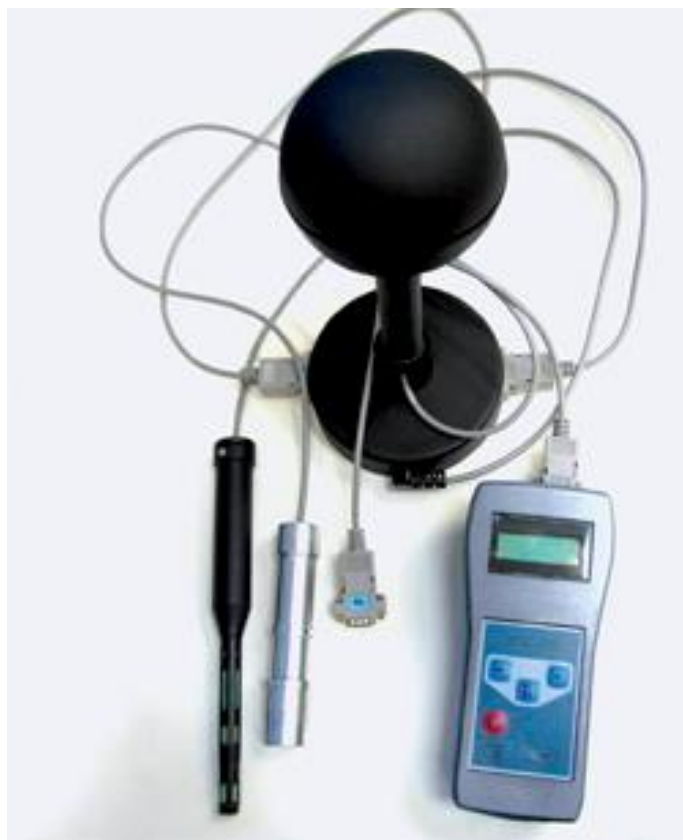
Рис.1. Метеометр МЭС-200: 1 - блок электроники; 2 - щуп измерительный Щ1; 3 - щуп измерительный Щ2
